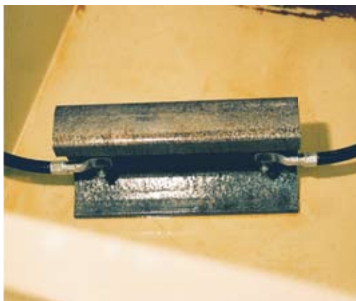
Badanie obszaru styku po próbach zanurzenia i długiego naświetlania.
